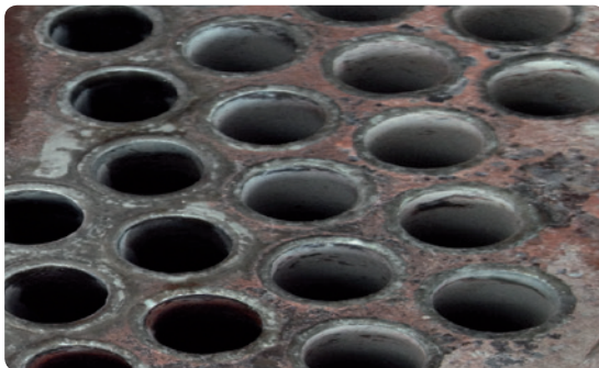
Los transformadores de calor convencionales se ensucian rápidamente. Las consecuencias: menor rendimiento, mayor consumo de energía.
