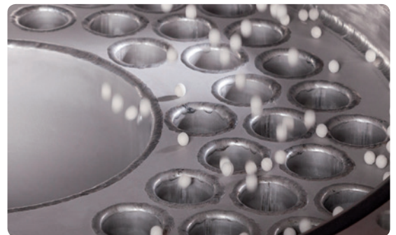
Un transformador de calor Activepowerclean se mantiene limpio de forma eficaz gracias a las bolas de cerámica en circulación.
