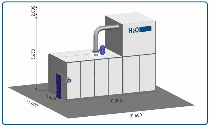
Dimensión del sistema de destilación al vacío VACUDEST con un área de mantenimineto óptima
